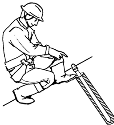
5. アンカー挿入
