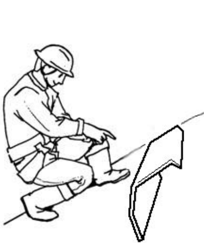
1. R型鋼板設置
