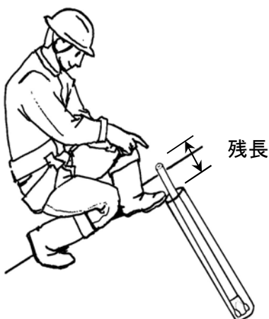
4. 削孔完了 (残尺検測)
